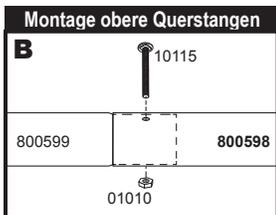
**WICHTIG:** Die Schraubenköpfe müssen nach außen zeigen um Schäden an der Abdeckung zu vermeiden.
